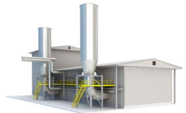
Ce sècheur à bande est protégé par un système de détection d'étincelles qui commande un système d'extincteurs automatiques installé au-dessus de la bande perforée.
