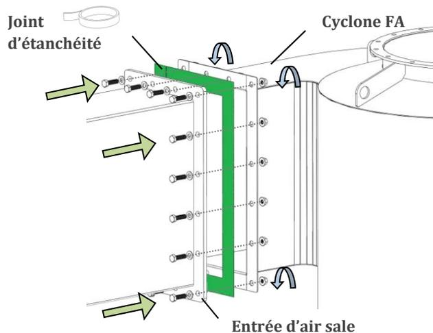
**Etape 3:** Utilisez un joint d'étanchéité sur la bride supérieure du cyclone et assemblez la tuyauterie sur la sortie air propre du cyclone avec les boulons adéquats.
