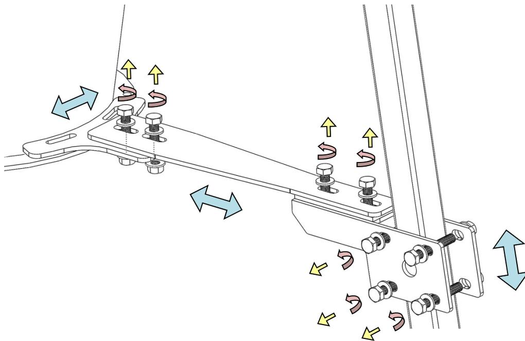
**Etape 6:** Attachez le support horizontal à la bride de la trémie du cyclone avec des boulons M10.
