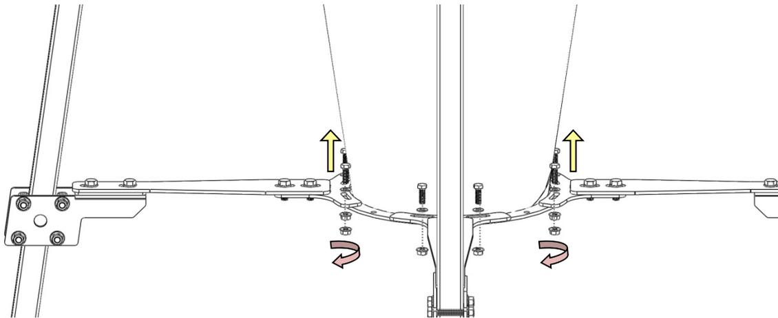
**Etape 3:** Utilisez un joint d'étanchéité entre la bride de la pièce de transition et la bride inférieure de la trémie du cyclone avec les boulons adéquats.
