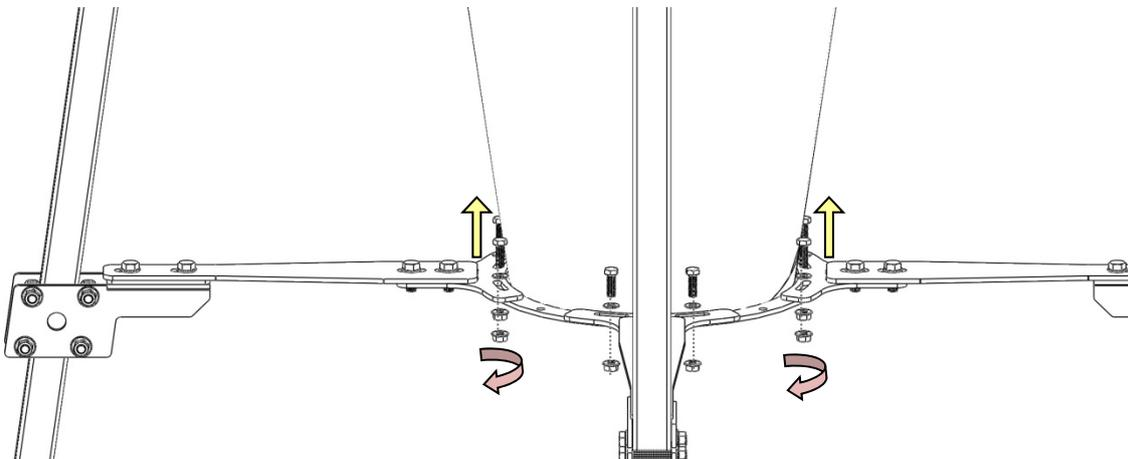
**Etape 3:** Déboulonnez les boulons des brides entre le corps et la trémie du cyclone.
