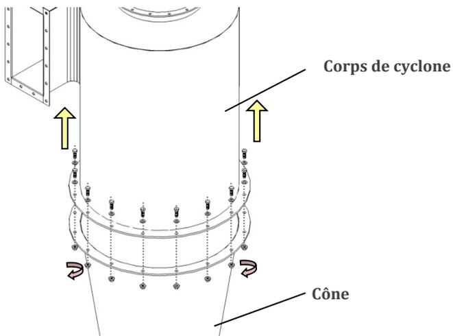
**Etape 2:** Remplacez le cône ou le corps de cyclone.
