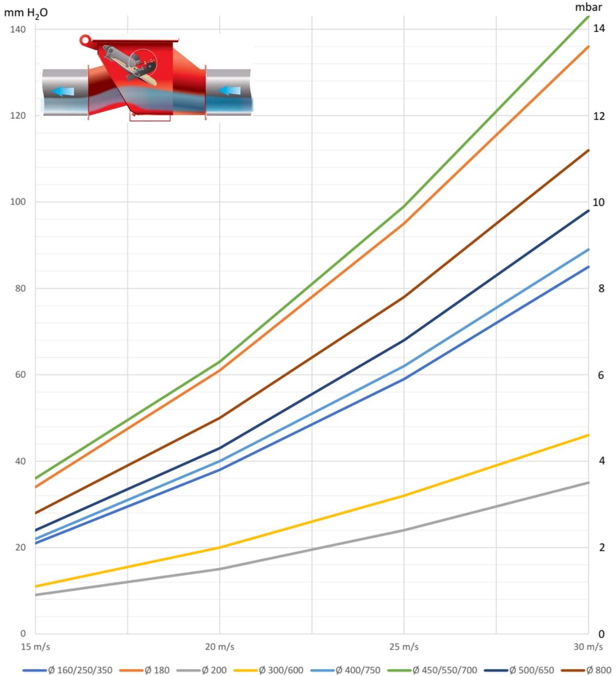
**12.1. Valeur de perte de charge (en mm H<sub>2</sub>O) mesurée à 20 m/s (TAB-9).**
