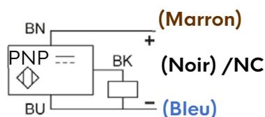
**9.2. Détecteur de position en option Ø12 pour zone ATEX -  $\text{Ex}$  II 2 D (DN≤350 - DN≤14"):**
