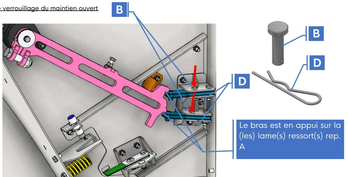
**i** Le système de blocage pour le maintien du clapet ouvert est différent selon la taille du BADA-VEX. Le nombre et la version des lames ressorts rep. A sont définis dans ce tableau (Tab-2) :
