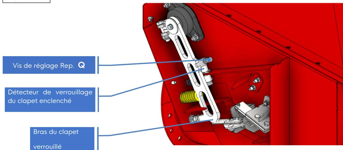
**9.1. Détecteur de position standard Ø12 hors zone ATEX (DN≤350 - DN≤14"):**
