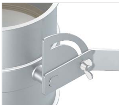
Détail de l'écrou papillon de blocage
