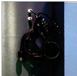
Raccordement facile par câble 230V et connexion air comprimé Ø8mm sur l'avant de l'unité.
