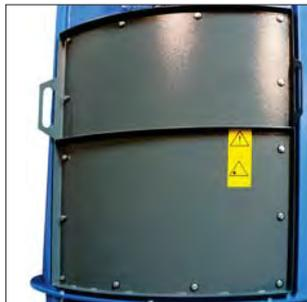
Porte d'accès facilitant l'inspection de la chambre cyclonique et le remplacement des cartouches.
