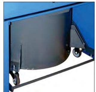
Seau de récolte en acier, avec raccordement rapide et facile par système Quicklock et roulettes.
