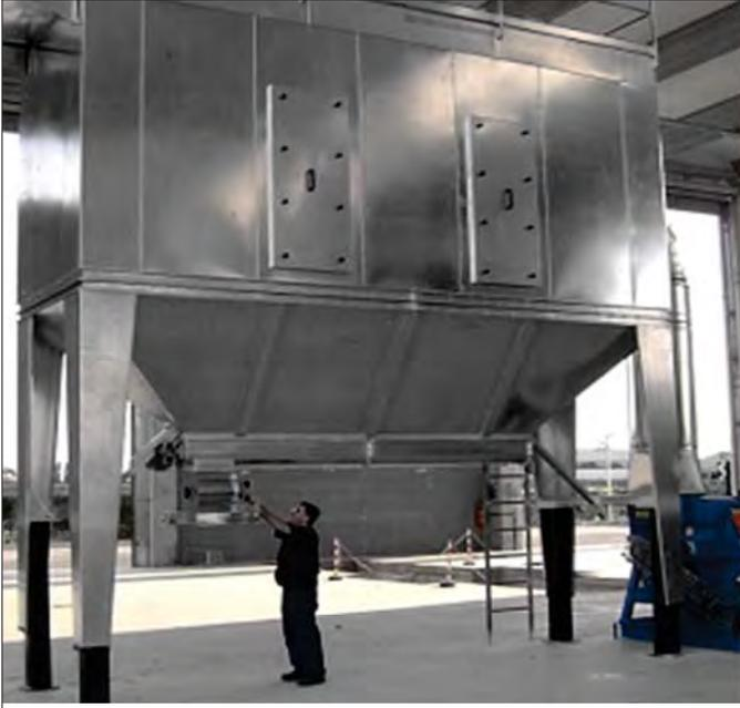
LBFEMP avec vis et écluse rotative
