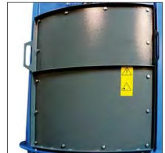
Contrôle visuel aisé des cartouches et de la chambre cyclonique par la porte d'inspection. (option)
