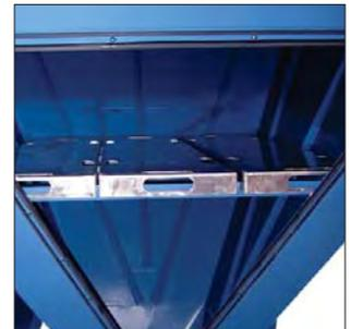
Points d'accroches pour placer un support pour le remplacement des cartouches.
