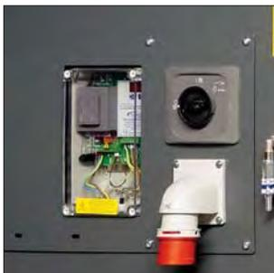
Alimentation du filtre et du ventilateur par prise triphasée CE 16 A sur face avant du dépoussiéreur. Air comprimé 6 bar, air sec, raccord type Cejn.
