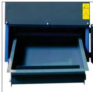
Seau de récolte en métal avec système Quiclock, placé derrière une porte d'accès.
