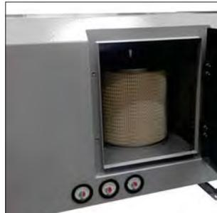
Porte d'accès à l'avant de l'unité pour une maintenance aisée des différents éléments filtrants.
