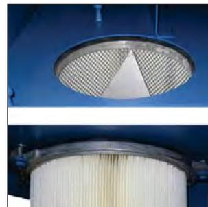
Remplacement rapide des cartouches par système baïonnette, placé derrière une porte d'accès.
