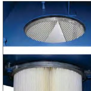
Les cartouches sont facilement remplacées coté air propre par le système de suspension à bayonnette. Tenez compte que cette procédure nécessite l'utilisation de sacs plastiques.
