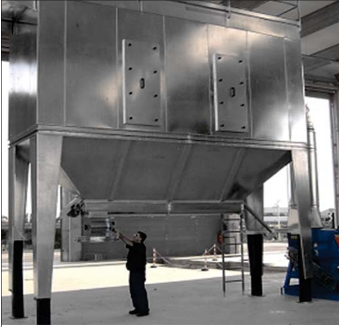
BFEMP mit Endlosschraube und Zellenradschleuse
