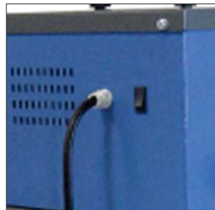
Start/Stop des Hochdrucksaugers durch Schalter
