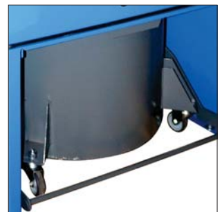
Quicklocker-justierbarer Staubbehälter auf 4 Rädern.
