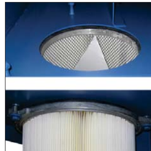
Een filterwissel en stofvrij gedaan worden door bayonet flens op de filterpatronen. Losmaken gebeurt vanaf de schone luchtzijde.
