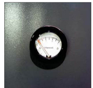
Voor eenvoudige bewaking van filtervervuiling kan de Minihelic drukverschilmanometer in de voordeur van HOUK worden ingebouwd.
