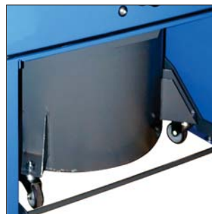
Eenvoudig te legen stofemmer Snelspanstelsysteem van de stofemmer zorgt voor een zeer eenvoudige lediging van de stof emmer.
