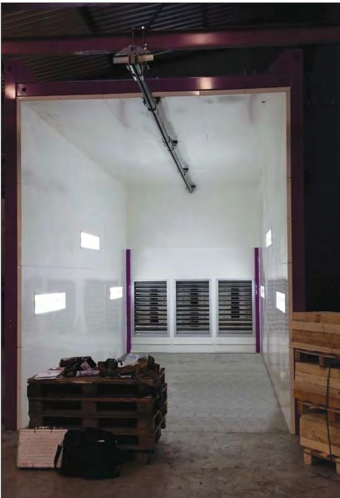
Vue de la cabine de poudrage avec mur aspirant intégré
