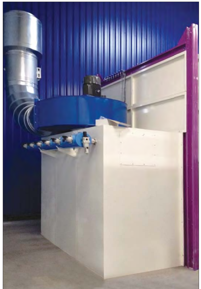
Saugwand mit montiertem Ventilator, vollständig in die Lackierkabine integriert
