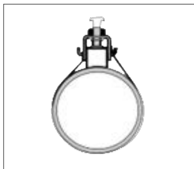
Positionsdetektor mit Spannband zur Befestigung am Zylinder
