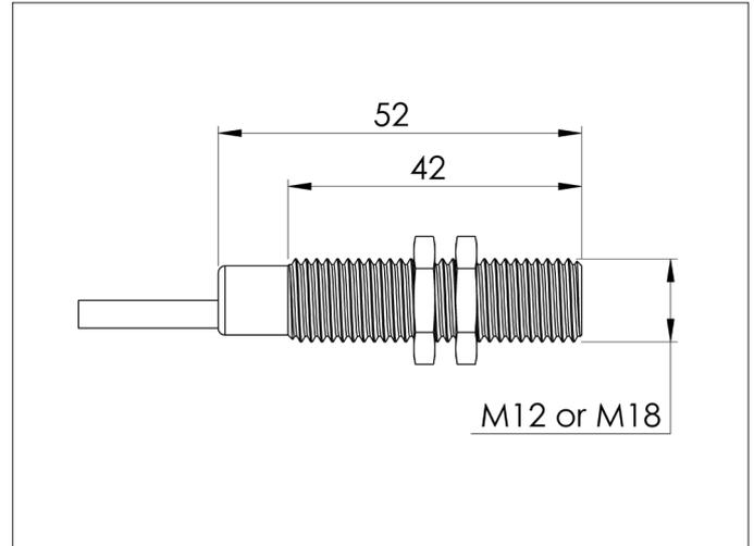
**NCEB - Capteurs de fermeture pour BADA-VEX**
