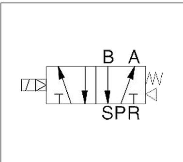
Schéma de raccordement de l'électrovalve
