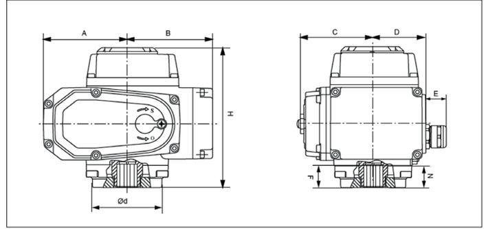
**NDAA Actuateurs électriques H-50 pour vannes papillon électriques AADL**
