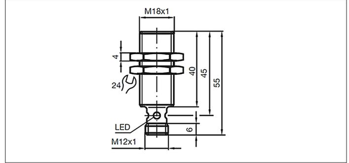
**Détecteur de rotation inductif M18 ATEX pour écluses rotatives RVA & RVB**
