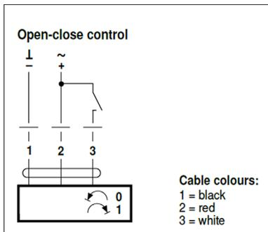
Schéma de raccordement de l'actuateur (ouvert/fermé)
