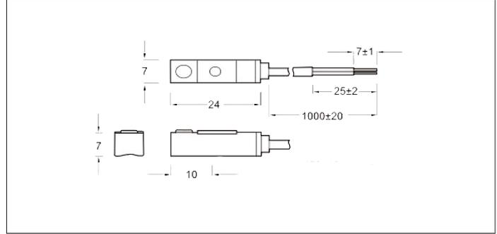
**NCEC Détecteur de position pour cylindres pneumatiques NDBB pour clapets**
