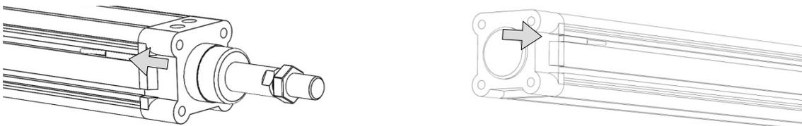
**HINWEIS:** Um eine ordnungsgemäße Funktion zu gewährleisten, stellen Sie sicher, dass die Positionsdetektoren maximal 3 cm von den Kanten des Zylinderkörpers entfernt sind.
